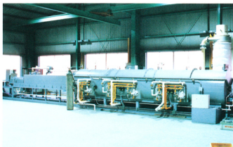
ステンレス鋼の溶体化処理、焼入焼鈍処理
